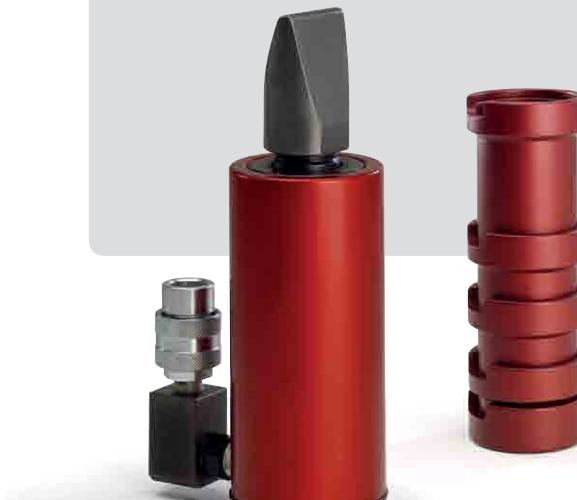
Utilizzato per stallonare il tallone interno dei pneumatici delle macchine movimento terra montati su cerchioni a 5 pezzi, si appoggia allo chassis e preme la parte laterale del cerchione. Costruito in acciaio e alluminio per una maggiore affidabilità e un peso ridotto. Consegnato con 5 prolunghe da 100, 50 (2), 30, 15mm. È dotato di innesto girevole a 360° per un miglior utilizzo senza intralci del tubo.
